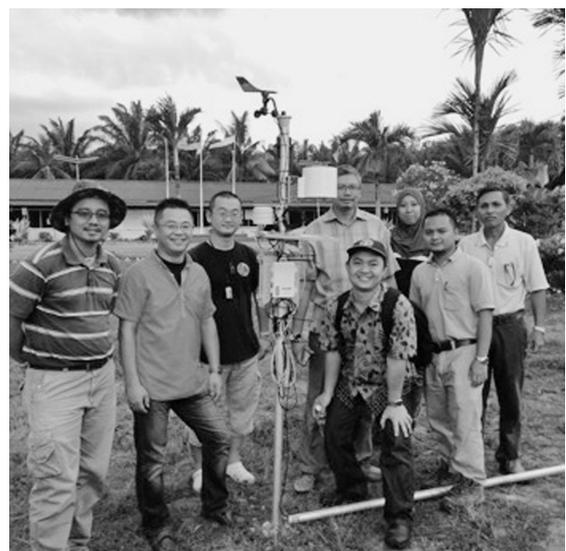
写真-4 クラウに設置したフィールドサーバ(デジタルカメラ画像、気温、相対湿度、土壌水分、風向・風速、日射量、降水量を観測できる。)
