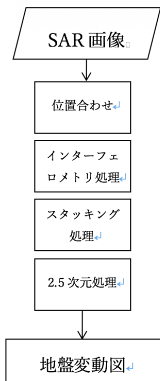
図1 干渉 SAR 処理の流れ
